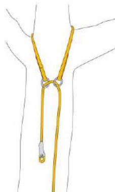
Fig. 8 - Ancoraggio passante per corda raddoppiata
