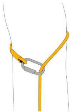
Fig. 2 - Strozzo diretto della fune
